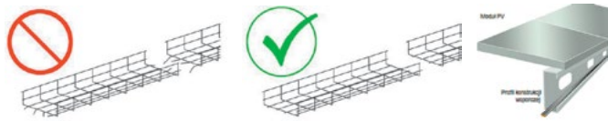
Rys. 6. Klatka kablowa z wolnymi końcami prętów i ostrymi krawędziami. Uwaga – Ryzyko uszkodzenia izolacji! Rys. 7. Usunąć końcówki prętów lub użyć ochraniaczy krawędzi. Rys. 8. Zalecana jest prowadnica kabla zintegrowana w konstrukcji wsporczej.
