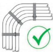
Rys. 13. Zmiana kierunku prowadzenia przewodów
