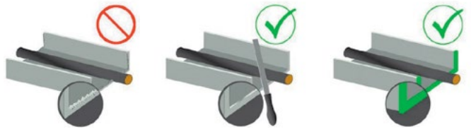
Rys. 3. Korytko z zadziorami. Uwaga – ryzyko uszkodzenia izolacji! Rys. 4. Gratowanie kanałów kablowych, tak aby izolacja przewodów pozostała nienaruszona przez dłuższy czas Rys. 5. Należy stosować ochronę krawędzi lub dodatkowo zabezpieczyć instalację w plastikowych rurach w obszarze krawędzi i ugięć przewodów.
